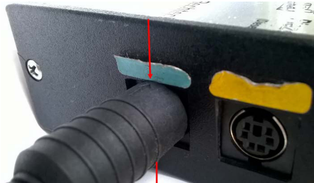
Abbildung: Anschluss des BV08089 am Drehzahlsimulator
