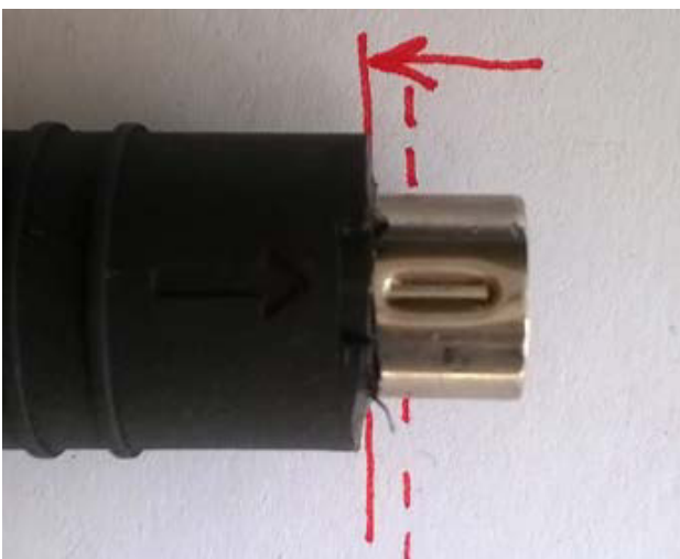
Abbildung: Gekürzte Stecker Ummantelung um ca. 3 mm
