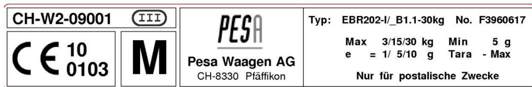
Korrektes Typenschild mit dem Aufdruck « nur für postalische Zwecke »
