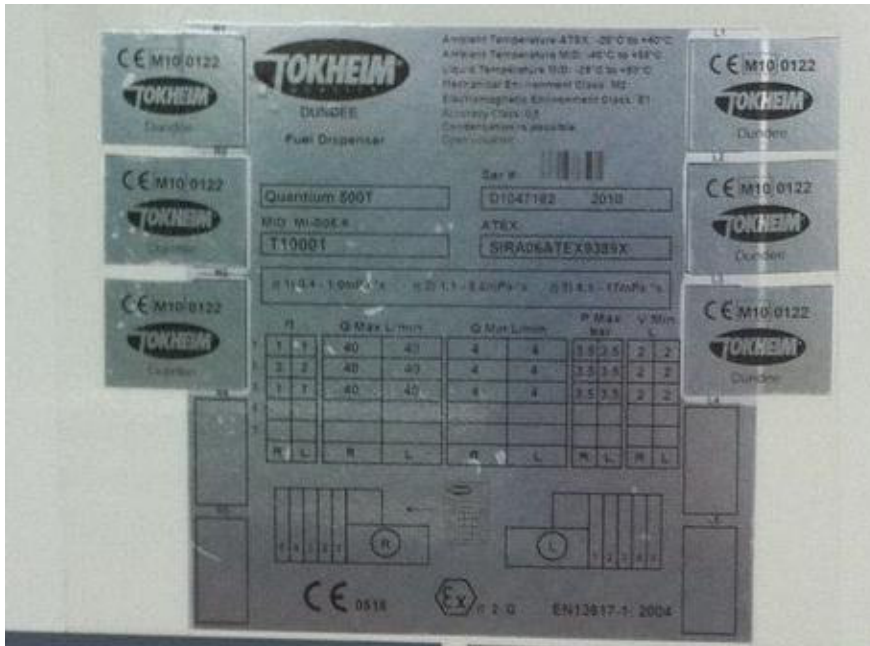
Kennzeichnungsschild mit korrekter Konformitätskennzeichnung
