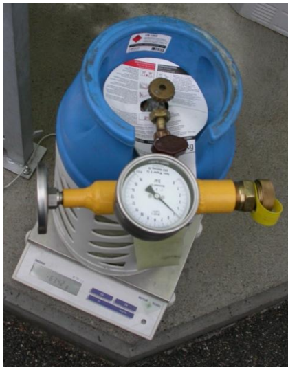
Bild 7: Wägen des Druckbehälters
