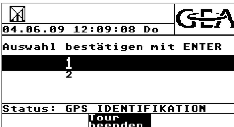
Ist eine GPS-Lieferanten-Datenbank in der **ZEVODAT-flash** hinterlegt, (optional, siehe Kapitel „Datenbankbeschreibung“), so wird für die jeweilige aktuelle GPS-Position überprüft, ob ein oder mehrere Lieferanten dieser Position zugeordnet werden können. Ist dies der Fall, so werden die gefundenen Nummern mit Namen (falls SN-Datenbank vorhanden) zusätzlich angezeigt.
