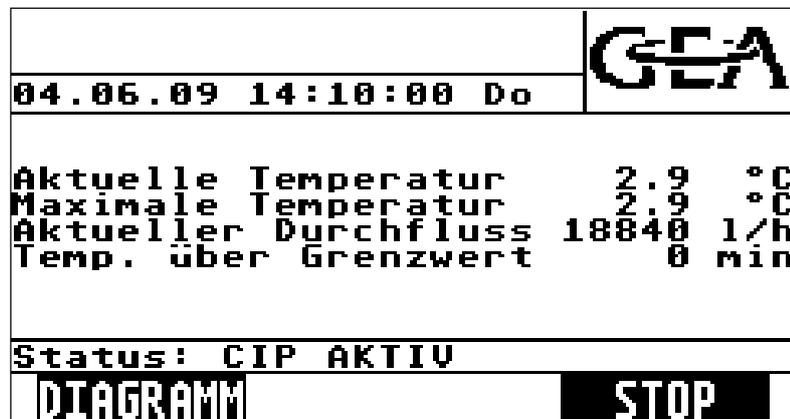
Während der Reinigung werden die aktuelle und die maximale Temperatur sowie der aktuelle Durchfluss angezeigt.
