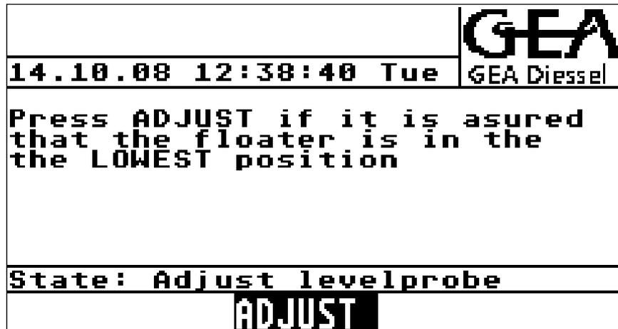
Drücken von Softkey **ADJUST** stellt die höchste Position des Schwimmers ein. Der Vorgang kann ohne Justierung rückgängig gemacht werden durch Drücken der Taste **ESC**
