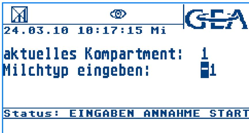
Beim Starten der Tour werden die Milchtypen, welche den Kompartiments zugeordnet sind, mit -1 initialisiert und sind damit nicht mehr zugeordnet.
